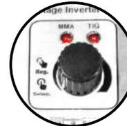
Perilla de regulación de amperaje y selección de proceso electrodo / Lift TIG
