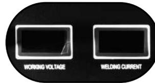
Pantallas de visualización LED de voltaje y amperaje
