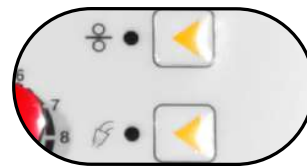
Función prueba alambre y gas en GMAW
