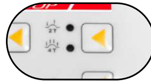
Función de soldadura GMAW 2 O 4 TIEMPOS
