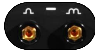
Dos posiciones para inductancia en MIG
