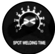
Función de soldadura MIG por puntos
