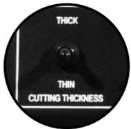
Selector de espesor a cortar
