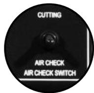
Selector de modo en corte o prueba de aire
