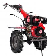
**MOTOCULTOR DIÉSEL CON ARRANQUE ELÉCTRICO Y BATERÍA - CON TRANSMISIÓN DIRECTA Y 6 VELOCIDADES**
