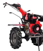
**MOTOCULTOR DIÉSEL CON ARRANQUE ELÉCTRICO Y BATERÍA - CON TRANSMISIÓN DIRECTA Y 6 VELOCIDADES + NEUTRO**
