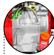
Aprox. ½ Litro de aceite SAE 10W30 (20W50 si T. ambiente ≥ 28 °C)
