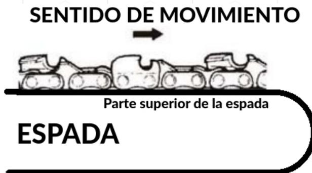
Instale el protector de cadena, atornille las tuercas y apriételas parcialmente, permitiendo que la espada se mueva un poco. Mientras sostiene la punta de la espada, ajuste la tensión de la cadena girando el tornillo tensor de cadena.
