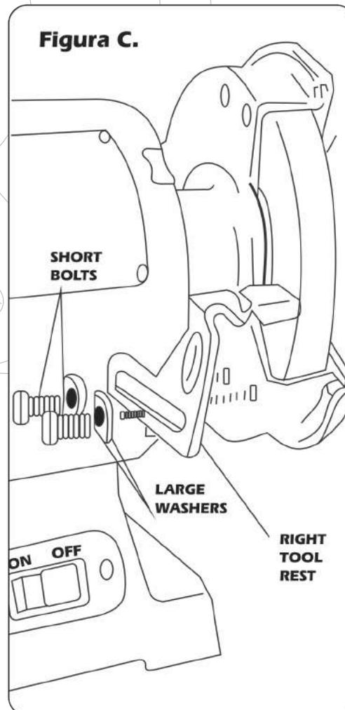
NOTA: Hay un apoya herramientas izquierdo y uno derecho. Remítase a la Figura C para ver su correcta instalación. Cuando estén en uso real, los apoya herramientas se deberán ajustar a 1/16" de la piedra de pulir o de los demás accesorios utilizados.
