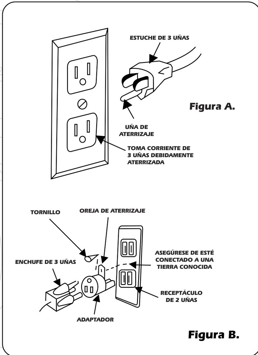
**Nota:** El adaptador que se ilustra es para utilizarlo sólo si usted tiene ya un receptáculo de dos uñas debidamente aterrizado.
