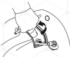
6 - Coloque un trapo limpio sobre el espacio donde estaba ubicada la bujía para evitar ingreso de partículas a la cámara de combustión.
