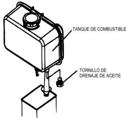
(1). Drene completamente el combustible del tanque de combustible.
