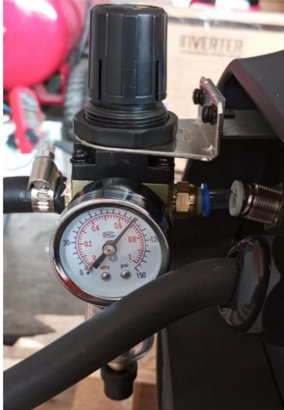
NOTA: para evitar fugas de aire es importante el uso de cinta de teflón en las roscas de los acoples que se atornillan al filtro regulador.
