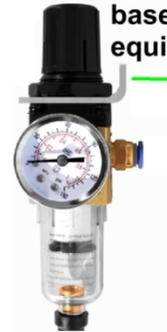
5. Atornillar el acople estriado para manguera en el filtro regulador.
