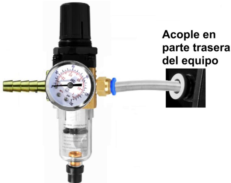
6. Insertar la manguera que viene del compresor en las ranuras del acople estriado y ajustar con la abrazadera metálica (no incluida).
