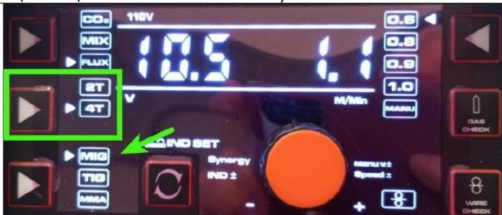
La opción de accionamiento de la antorcha en modo 2T y 4T se usa para reducir la fatiga del operario de soldadura. A continuación se explica el uso y funcionamiento de los dos modos de accionamiento de antorcha.
