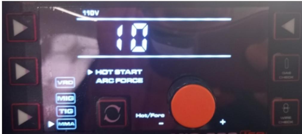
Por otro lado, si se ajusta el Hot start en 10, el equipo suministrará un adicional de 10% cuando se esté cebando el arco. Ejemplo, si se había ajustado un amperaje de soldadura de 100 amperios, el equipo 442-MG200 suministrará 110 amperios (el 10% adicional) durante menos de un segundo (aproximadamente 0.3 segundos) cuando se esté iniciando el arco y cuando se esté soldando el amperaje de soldadura será de 100 amperios.
