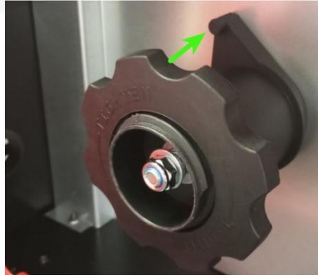
Adicionalmente, en cuanto a la alineación se debe tener en cuenta que el alambre debe salir por debajo del rollo, para que se alinee correctamente con la guía de entrada del alimentador
