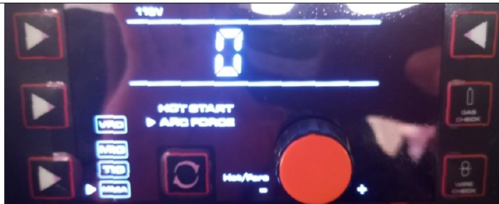
Al presionar dos veces el botón señalado con flecha verde se observa que la opción en pantalla "ARC FORCE" se ilumina, con lo cual se podrá ajustar esta función en un valor entre 0 y 10, girando la perilla de ajuste de parámetros.
