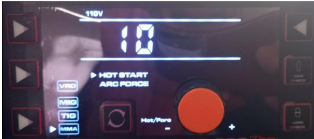
Por otro lado, si se ajusta el Arc Force en 10, el equipo suministrará un adicional de 10% cuando se esté cebando el arco. Ejemplo, si se había ajustado un amperaje de soldadura de 100 amperios, el equipo 442-MG200 suministrará temporalmente 110 amperios (el 10% adicional) mientras el operario corrija la distancia entre la punta del electrodo y la pieza a soldar y cuando se esté soldando a la distancia correcta el amperaje de soldadura será de 100 amperios.
