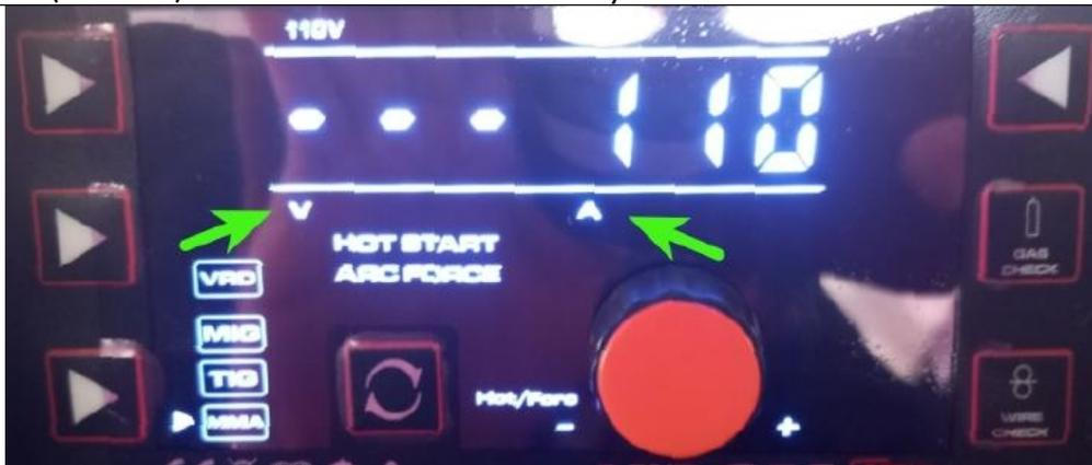
Al estar activada la función MMA, y ver en pantalla las letras V (Voltaje) y A (Amperaje) arriba señaladas con flecha verde, se puede girar la perilla para subir o bajar el amperaje de soldadura, en los rangos enunciados en la sección 2 “ESPECIFICACIONES TÉCNICAS”, según el voltaje de conexión.
