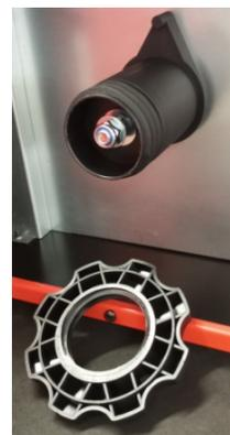
Se instala el rodillo, alineando su agujero guía lateral, con el pin guía del eje portarrollo.
