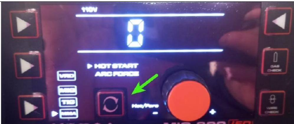
Si ya se ha definido el amperaje de soldadura y al presionar una vez el botón señalado con flecha verde se observa que la opción en pantalla “HOT START” se ilumina, con lo cual se podrá ajustar el hot start en un valor entre 0 y 10, girando la perilla de ajuste de parámetros.
