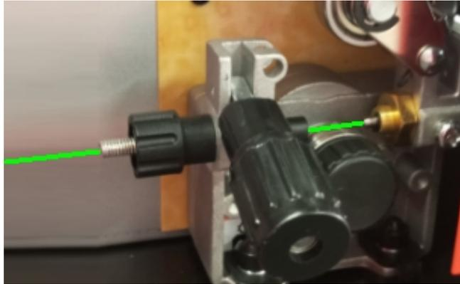
Tener en cuenta que el alambre pasará por la ranura del fondo del rodillo ( ver foto abajo). El rodillo original, que se proporciona con el equipo 442-MG200 viene marcado por un lado con 0.8 mm (para alambre 0.030" y 0.035") y por el otro lado está marcado con 1.0 mm (para alambre 0.040").
