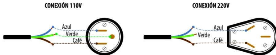
VERDE - TIERRA: Para conectar a tierra. Nunca para conectar a neutro (110V), ni para conectar a línea energizada (220V)
