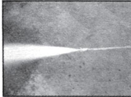
**40° Boquilla Blanca,** Esta boquilla entrega un patrón de aspersión de 40 grados y una corriente de agua menos potente. Cubre un área amplia de limpieza. Esta boquilla puede ser usada para la mayoría de los trabajos de limpieza en general.
