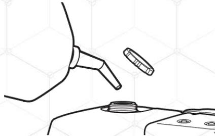
5.3.1 Apague la hidrolavadora y déjela enfriar al menos por un periodo de 2 minutos antes de remover la tapa del tanque de combustible. Al aflojar la tapa del combustible hágalo despacio para liberar presión.
