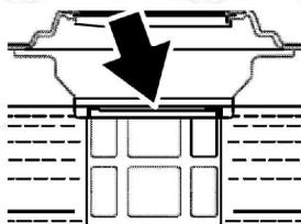
5.2.7 Instale la tapa de combustible girando en sentido de las agujas del reloj. Asegúrese que la tapa está correctamente apretada.
