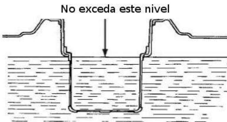
Abra la tapa del tanque de combustible y aplique gasolina hasta que el indicador de combustible llegue a lleno. Tenga la precaución de que el nivel de gasolina no exceda el nivel del filtro de gasolina como se indica en la figura.
