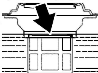
5.3.7 Instale la tapa de combustible girando en sentido de las agujas del reloj. Asegúrese que la tapa está correctamente apretada.
