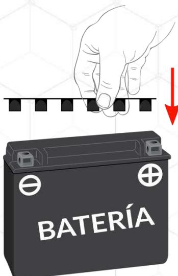
5.4.8 Espere de 30 a 60 minutos para que el ácido realice su reacción química en conjunto con las placas internas de la batería.
