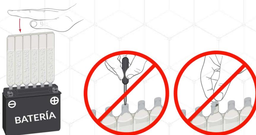
5.4.5 Como indica la imagen anterior, uniformemente empuje este contenedor de ácido de tal forma que la batería rompa el protector del contenedor de ácido.
