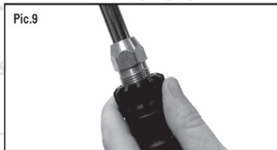
Instalar el conector de manguera de alta presión al conector que se encuentra en el lado inferior del sistema de pistola (Fotografía 10) (10.1) Asegurándose que esté bien apretada. No apretar demasiado, ya que esto podría dañar los conectores.
