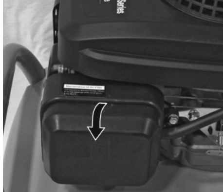
Figura 24 – Remoción de la Tapa del Purificador de Aire
