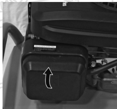
Figura 27 – Instalación de la Tapa del Purificador de Aire
