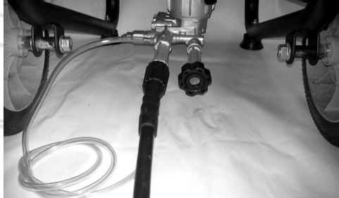
Figura 9 – Instalación de la manguera de alta presión 1 – Manguera para jabón 2 – Accesorio de la manguera
