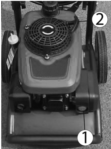
Figura 17 – Puesta en marcha del Motor 1 – Botón de encendido 2 – Manija de Recogimiento 5. ente y halar
