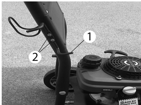
Figura 6 – instalación del soporte de la pistola de aspersión (spray) 1 – soporte de la pistola de aspersión (spray) 2 – Pernos y tuercas M5
