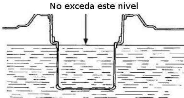
Abra la tapa del tanque de combustible y aplique gasolina hasta que el indicador de combustible llegue a lleno. Tenga la precaución de que el nivel de gasolina no exceda el nivel del filtro de gasolina como se indica en la figura.
