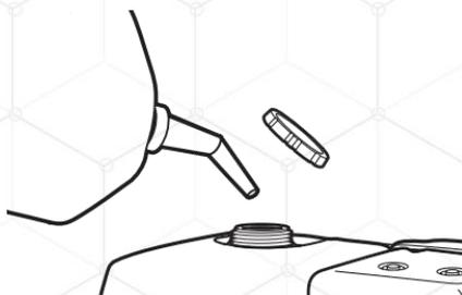
4.4.1 Apague la hidrolavadora y déjela enfriar al menos por un periodo de 2 minutos antes de remover la tapa del tanque de combustible.
