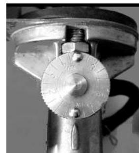
6. Ajuste la válvula de paso de combustible de acuerdo a los requerimientos, cuando escuche el sonido crujiente significa que el equipo está funcionando correctamente. **Si tiene problemas para encender el equipo**, repita desde el paso c) hasta el paso.
