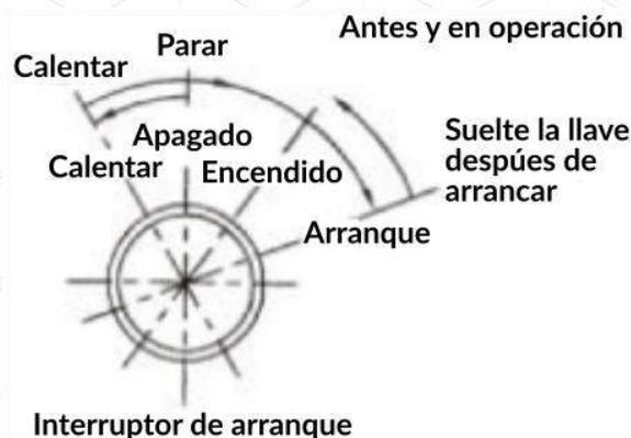
**Apagado "OFF":** Esta es la posición de parada del motor, y toda la corriente eléctrica está cortada. La llave se puede insertar y quitar en esta posición.
