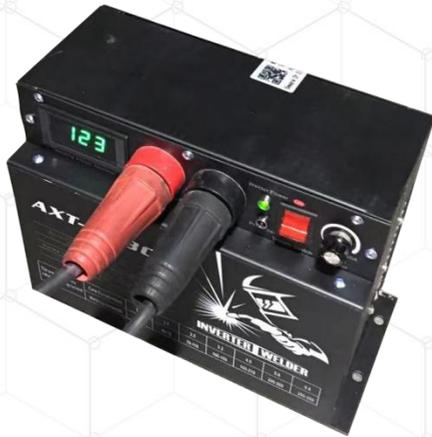
En panel de control para la operación de soldadura usted encontrará un display digital que indica la corriente de trabajo. Conectores positivo y negativo para la conexión del portamasa y porta electrodo. Switch de encendido y apagado de para la función de soldar del equipo y por ultimo una perilla para la selección de la corriente de soldadura a elegir.
