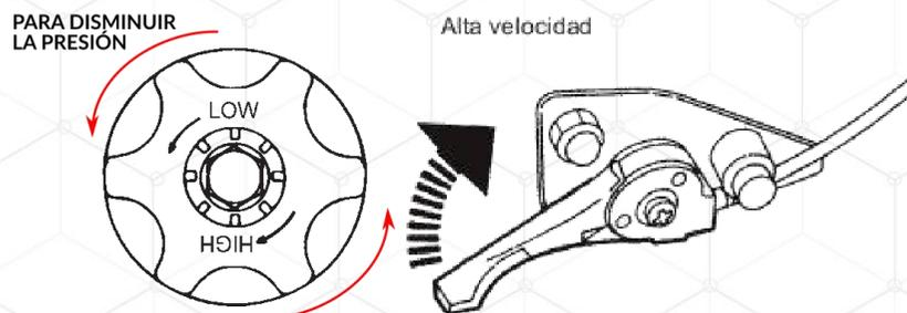
6.2.4 Cada 2 horas de operación realice 2 giros a cada grasea. La Fumigadora de espalda 499-KPS25-A no requiere uso de graseras para la lubricación de los pistones.
